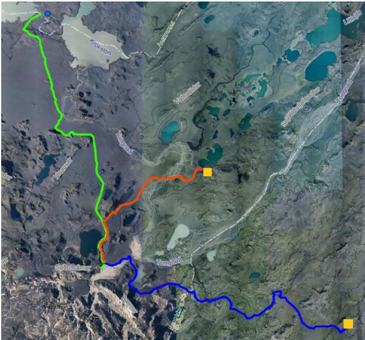
Mynd 16. Mögulegar leiðir fyrir jarðstrengi frá ofangeindum svæðum (birt með fyrirvara um gróft teiknaðar hugmyndir er liggja meðfram vegum eða línuslóðum.) Aðveituskúrar eru sýndir með gulum kassa en aðveitustöð við Sigöldu sýnd með bláum hring.
